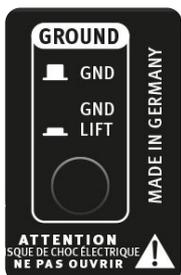
Mit dem Schalter Ground auf der Rückseite des MixDream Mk2 können Brummschleifen behoben werden, indem bei gedrücktem Schalter die interne Masse von der Gehäusemasse getrennt wird.
