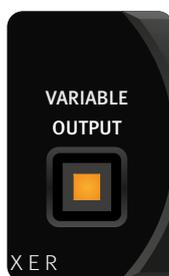
Der Output-Regler wird mit dem Variable Output-Schalter zu- oder abgeschaltet.
