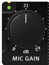
Über den Gain-Regler wird die Vorverstärkung eingestellt. Der regelbare Vorverstärkungsbereich liegt zwischen +8 und +62 dB.
