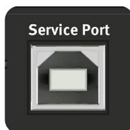
Der Service Port (USB) am optionalen AD-Wandler des P8 sorgt dafür, dass die digital Schnittstelle einfach gewartet werden kann. Er dient zum Übertragen der Betriebssoftware (Firmware) und ist nicht für Audio-Verbindungen vorgesehen.
