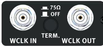
Das Word-Clock-Anschlussfeld des optionalen AD-Wandlers beinhaltet je einen Clock-Ein- und Ausgang, sowie einen Schalter zur Terminierung des Clock-Eingangs.
