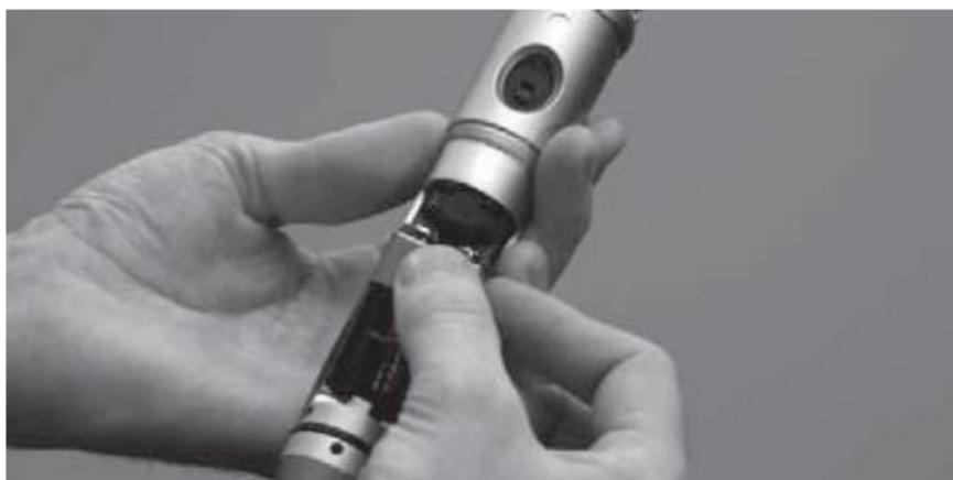
4. 将电池推入到位，使其与空腔顶部平行。通过翻转电池夹使电池处于电池上，将电池固定在适当的位置。
